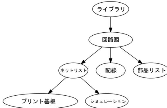
シンボルはシンボルライブラリーから回路図へと配置されます。回路図が完成した後で、PcbNew が回路の接続情報とフットプリントをインポートできるように、ネットリストが作られます。
