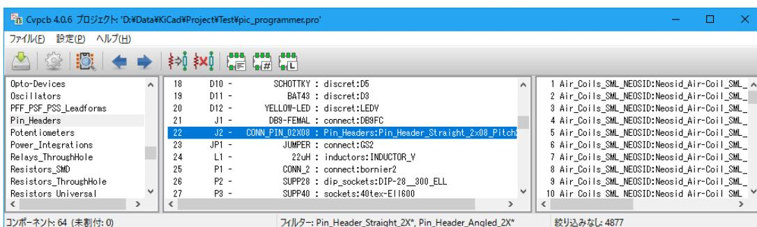
選択されたコンポーネントに関連付けされたフットプリント・フィルタのリストによるフィルタ。コンポーネント・フィルタはメイン・ウィンドウ下部にあるステータス・バーの中央部分に一覧表示されます。
