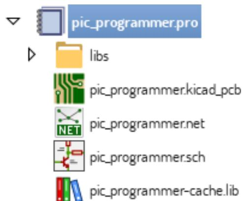
回路図ファイルをダブル・クリックすると回路図エディターが起動し、この例では `pic_programmer.sch` というファイルを開きます。
