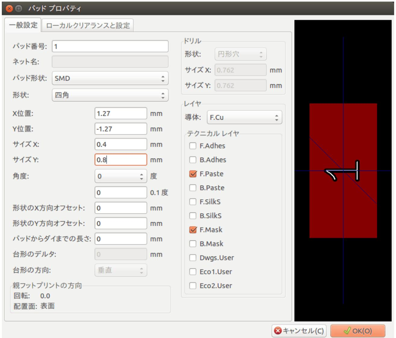
5. パッド番号を 1 に、形状を 四角 に、パッド形状を SMD に、サイズ X を 0.4 に、サイズ Y を 0.8 に設定し、OK をクリックします。再度 パッド入力をクリックし、もう 2 つパッドを配置します。
